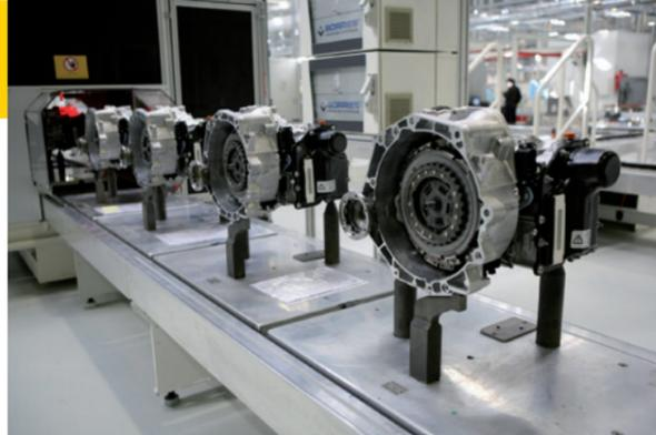
DSG Doppelkupplungsgetriebe DQ200
